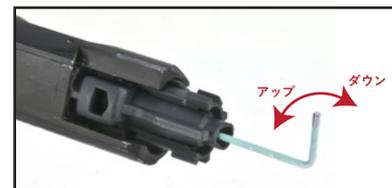
ノズル側から見た際に、反時計回りに回すとフローバルブが後退して初速が上がり、時計回りに回すとフローバルブが前進して初速が下がります。
