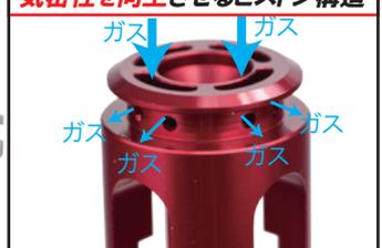
ブローバックの際、ガスをピストンから入り、Oリングが広がり、気密性を向上させます。
