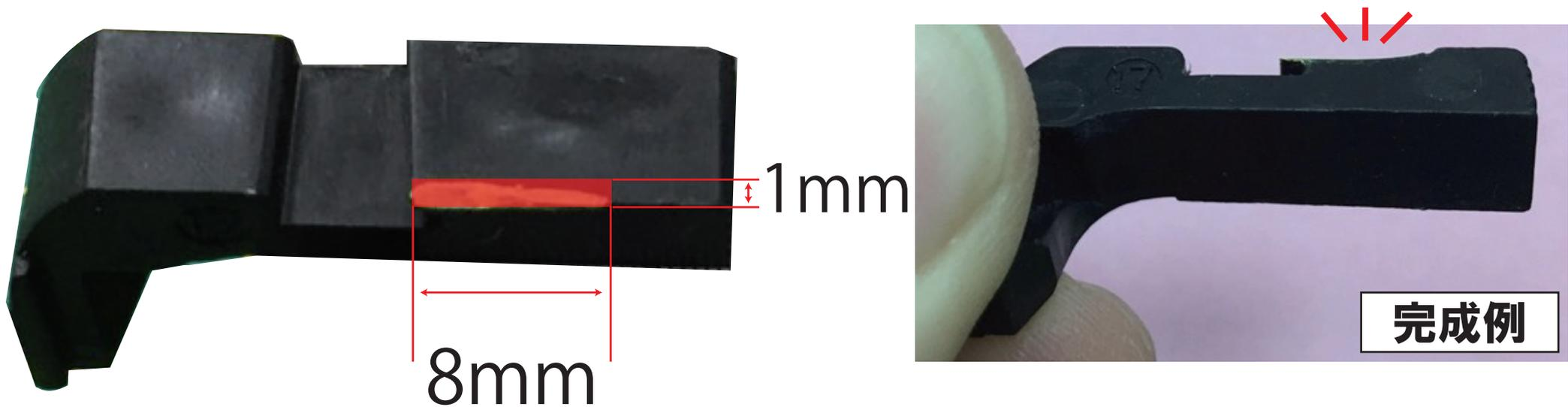
上記赤い部分の角をヤスリ等で削ってください。8mm 以上削ると、削った部分がフレームから飛び出します。
