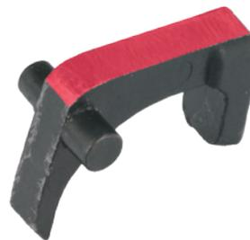
コッキングインジケータ (純正パーツ No.VGCCFPN020) が正常に作動しない場合は画像の赤い部分を 0.1mm 程度削って下さい。
