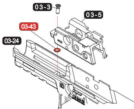
フロントシャーシ (03-5) を外す作業を行った場合、フロントシャーシとフレームの間に入っている円形の金属板 (03-43) を組み込むのを忘れないようにご注意ください。組み込み忘れた場合、作動不良の原因となります。
