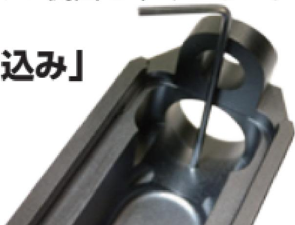
サイトをスライドに組み込み、裏側の穴とサイトのネジ穴を合わせます。そして、六角レンチを穴に入れ、ネジを緩める事により固定されます。
