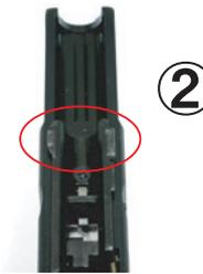
スライドストップノッチのめくれ防止の為、①の赤丸の形状が純正と異なり、スライドをフレームに組み込む際、②の赤丸部分と干渉してしてしまいます。その為、純正と同じ方法ではスライドを組み込む事が出来ません。
