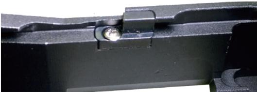
スライドストップノッチ強化パーツ(D)をはめ込み、ネジ(E)で固定します。
