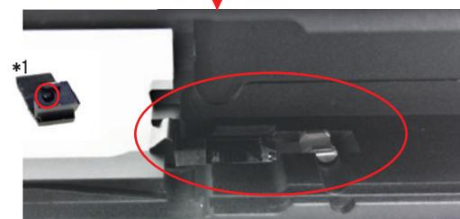
エクストラクター (A) の穴\*1 とエクストラクタープランジャー (B) の出っ張り合わせながら組み込みます。
