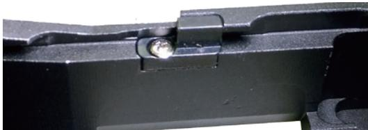
スライドストップノッチ強化パーツ (D) をはめ込み、ネジ (F) で固定します。
