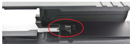
エクストラクタープランジャー (B) をはめ込みます (スライドの内側の溝にはめ込むだけです)
