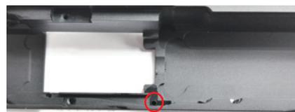
組み込んだ状態で、赤丸の部分の穴が見えれば正規の位置にエクストラクターが組み込まれています。
