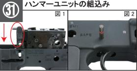
図1のようにロアレシーバーに純正ハンマーユニットを組込みます。 この際赤丸部分の純正ボルトキャッチ及び純正ボルトキャッチ スプリングの組込み忘れに注意してください。
