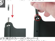
図のように純正のフレームピンストッパーと フレームピンストッパースプリングを抑え込むように 純正フレームピンを溝の位置を合わせて押し込みます。 ※この際、フレームピンストッパーとフレームピン ストッパースプリングを飛ばしてしまわないよう 注意してください。
