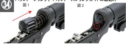
項目⑨の逆の手順で図2のようにバッファースプリング、バッファースプリングガイドを組み込みます。 図2の赤丸のパーツ(バッファーストッパー)を押し下げながらバッファースプリングガイドを
