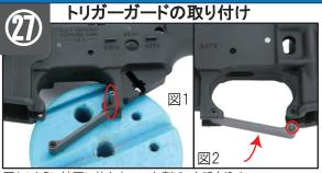
図1のように純正に使われていた割ピンを叩き込み、 トリガーガードを固定します。
