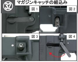
項目⑬の逆の手順でマガジンキャッチを組み込みます。 まず、図1のように左側からマガジンキャッチをはめ込み 図2のように右側からマガジンキャッチスプリングを組み込みます 次に図3のようにマガジンキャッチボタンを組み込みます。 次にマガジンキャッチボタン側から押し込み、図4のように マガジンキャッチを回転させ、定位置に戻します。
