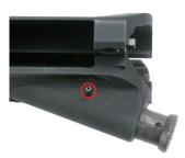
図の様にフォワードアシストノブを差し込み、付属のピンで固定します。 ※ピンを組み込む場合、しっかりとノブを奥まで押し込み、ピンにあたるものがないこと を確認したうえで組み込んでください。アシストノブが定位置に来ていない状態で 無理にピンを組み込もうとすると、破損するおそれがあります。
